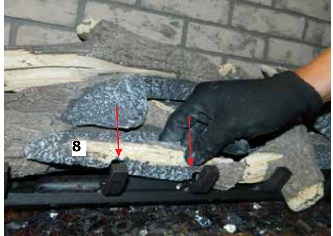
Schéma 14 - Installation de la bûche 8
