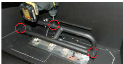
Schéma 2 : Glisser le brûleur vers la droite puis l'enlever.
